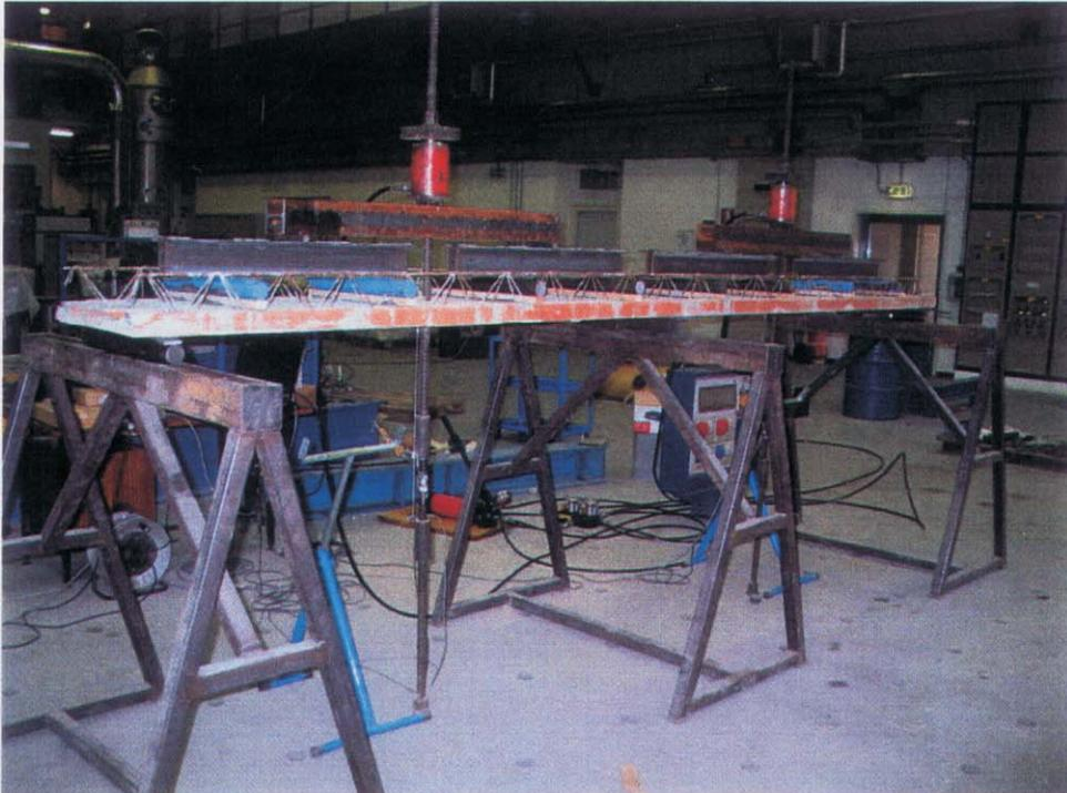
Fotografia 7: Prova di flessione con carico distribuito su tre appoggi
